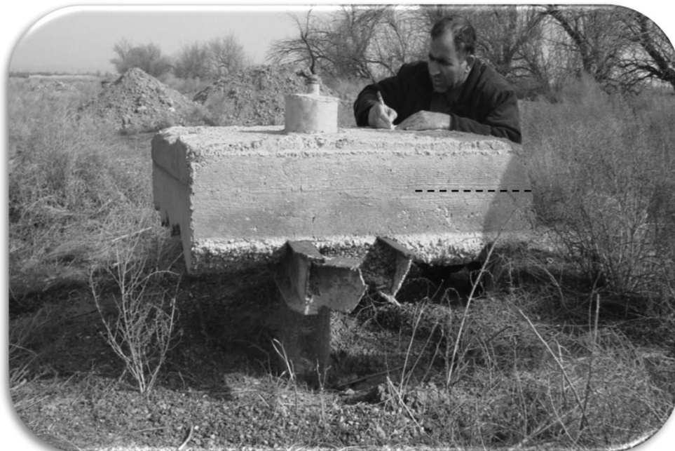
شکل ۵- نمایی از نشست ۷۰ cm زمین در اطراف بیژومتر روستای وایقان دشت شبستر - صوفیان (غفوری، ۱۳۸۹)
