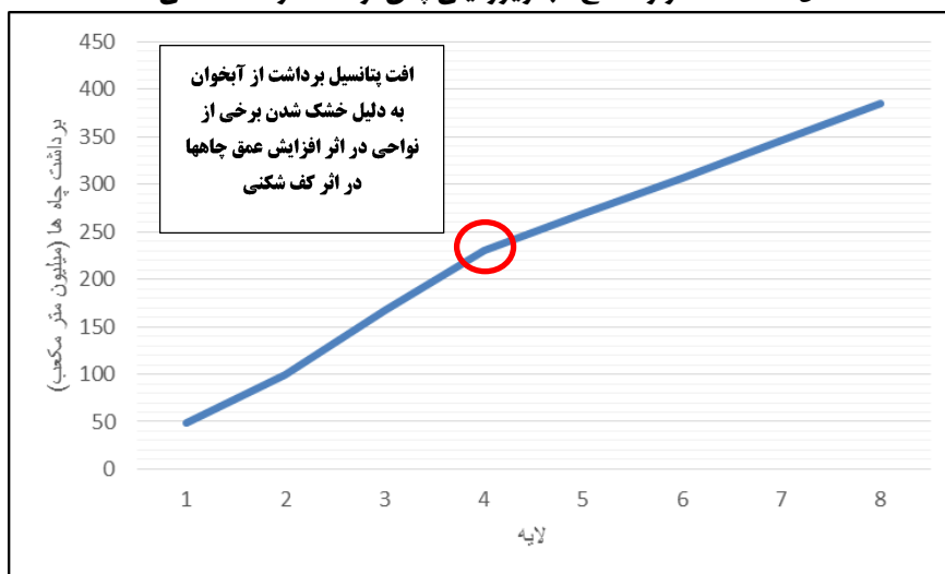
شکل ۶- نمودار تغییرات پتانسیل برداشت از آبخوان در برابر افزایش عمق چاههای بهره برداری
