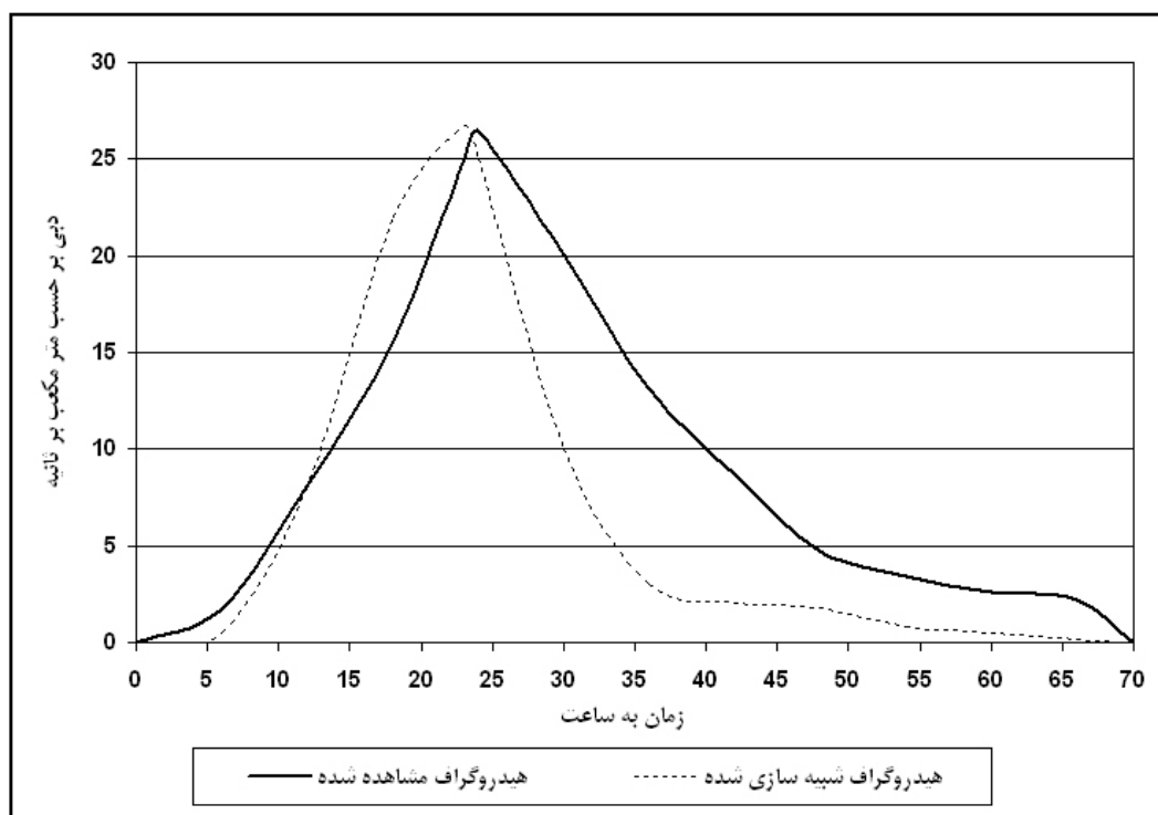
شکل ۵ - آبنمود مشاهده‌ای و شبیه‌سازی در مرحله واسنجی رویداد ۲۰ تا ۲۲ فروردین ۱۳۷۸ در ایستگاه هیدرومتری تمر
