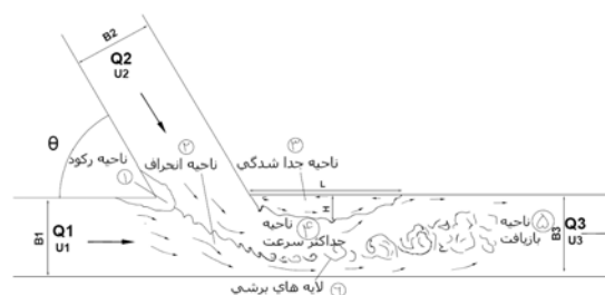
شکل ۱ - الگوی جریان در محل تلاقی کانال‌های روباز
