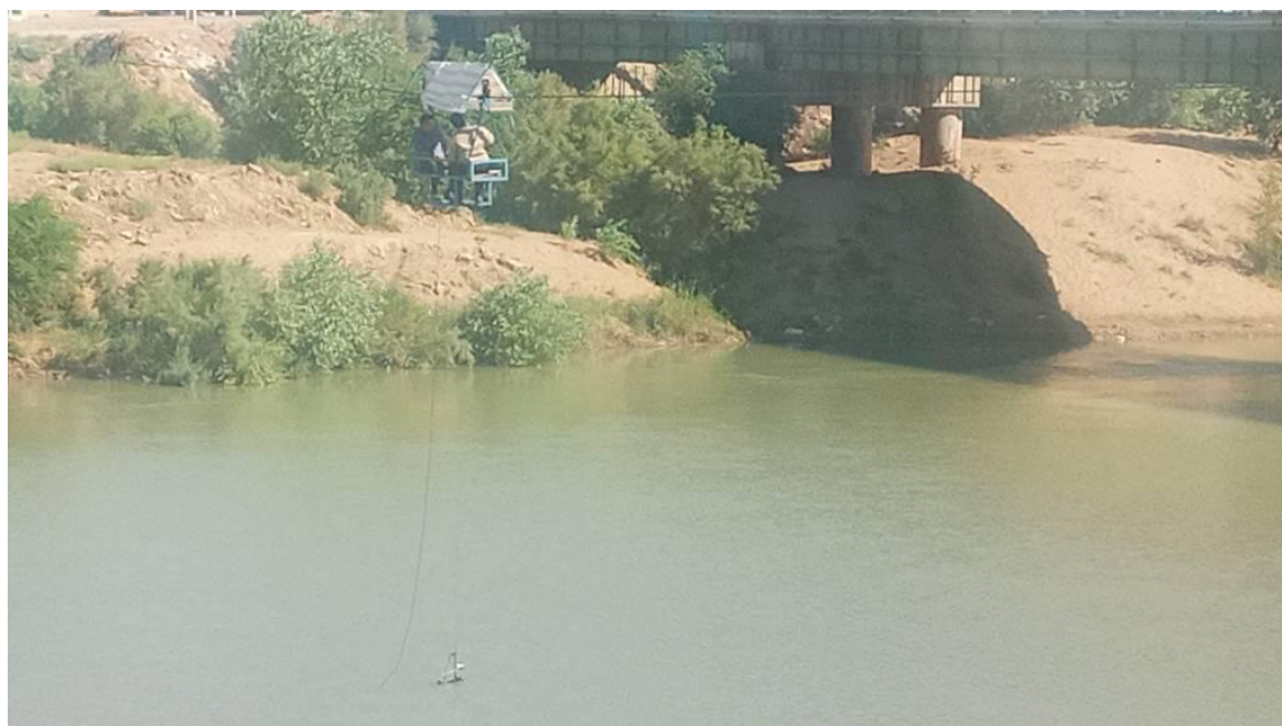
Fig. 2- Measuring the discharge of the Karkheh River using the cableway and Velocity Current Meter شکل ۲- در حال اندازه گیری دبی رودخانه کرخه با استفاده از پل تلفریک و مولینه
